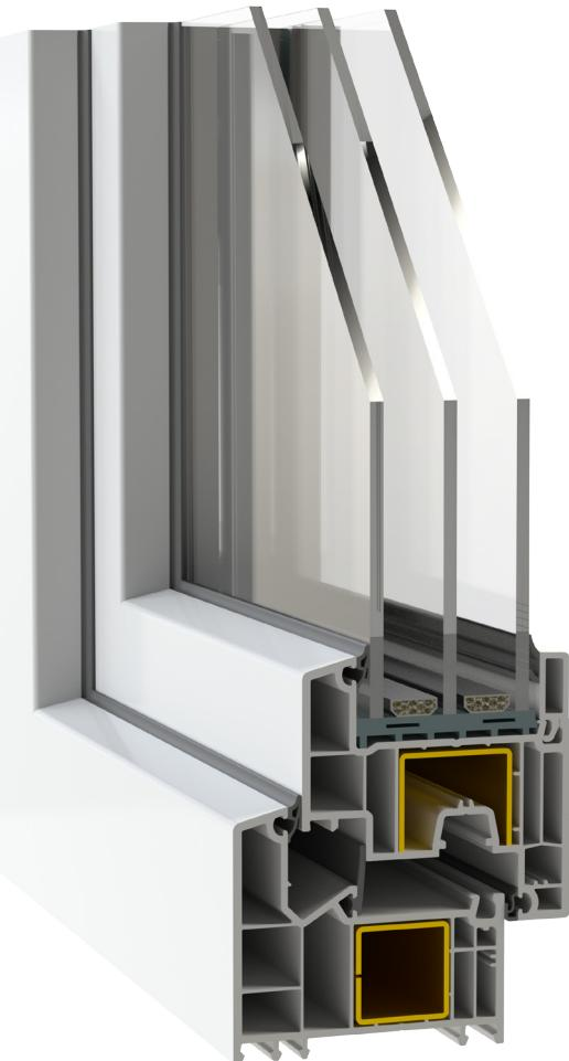
Decco 84MD je ultramoderní systém se stavební hloubkou 81 mm a třetím pružným středovým těsněním, které nabízí rozšířené výztužné komory pro větší tuhost okna. Díky optimalizované výšce profilu poskytuje systém až o 5 % více světla než jiná řešení v této třídě.
